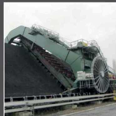
Приводной кабельный барабан на мостовом реклеймере, США
