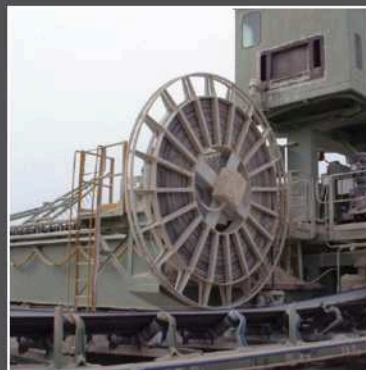
Барабан рядной намотки на стакере-реклемере, США
