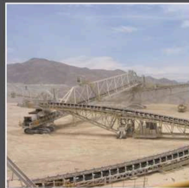
Подвесная система на мобильной загрузателе, Чили
