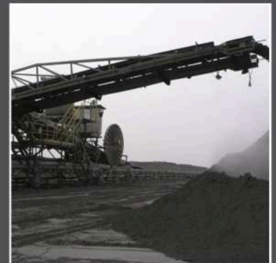
Приводной кабельный барабан на Стакере, Чехия
