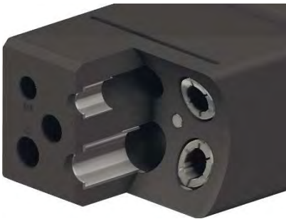
Bagues antiviol intégrées dans le nez de fiche limitant l'ouverture de l'avant des contacts Rings into the noze to limit opening of the female slotted sleeve contact
